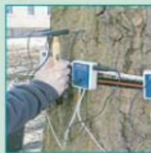
3. Yケーブルとハンマーを用いて全部の鉄釘をノックする
