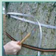
2. ストラップにモジュールを装着、釘にセンサーを取り付ける
